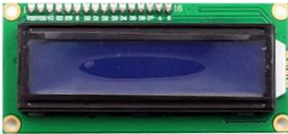
Přední část displeje (nahore vidíme 16 ovládacích pinů)
